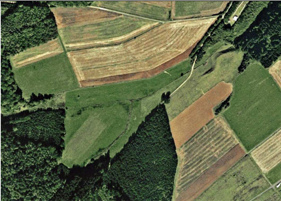
Zustand Molkenbach westlich der Ortslage von Elchweiler: kein Uferrandstreifen bzw. Gewässerentwicklungskorridor, starke Eintiefung und Begradigung (Luftbild Google Earth)
